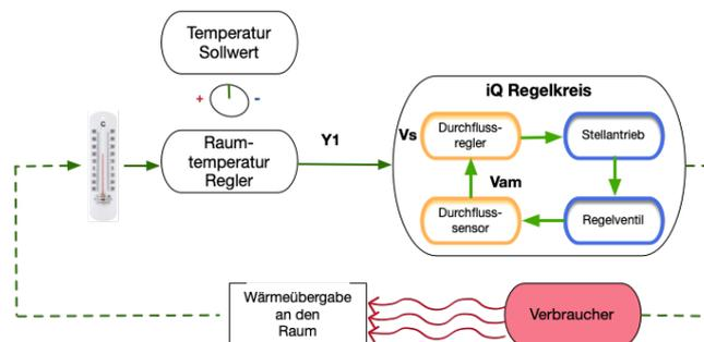
Störungen der Durchflussmenge im Rohrnetz kann der konventionelle Regelkreis nicht erfassen.
