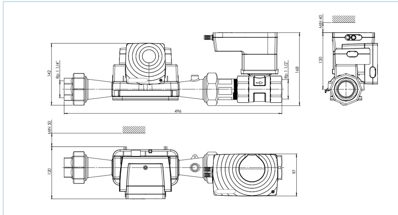
Achtung: Abweichende Abmessungen bei den Ausführungen mit Sicherheitsfunktion. Bitte im Werk erfragen.
